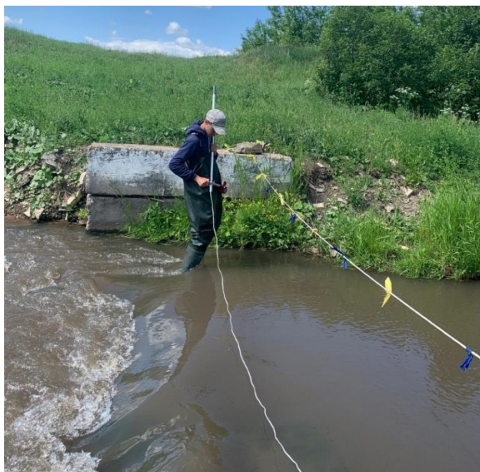
Измерение скорости течения р. Курсак до Слакского водохранилища с помощью ИСП-1 (54,001989° с. ш., 54,655390° в. д.)
